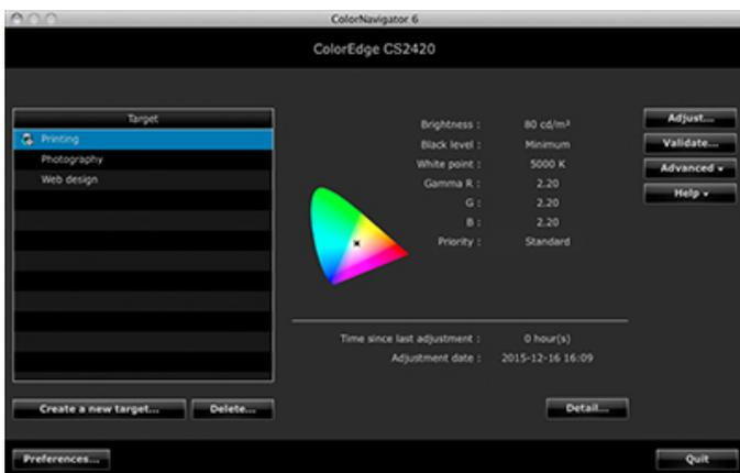
Afin de garantir une gestion des couleurs pertinente dans votre travail, il est nécessaire de maintenir des paramètres de calibration. Le logiciel ColorNavigator - fourni avec le CS2420 - vous permet de vous charger vous-même de ces paramètres en toute facilité. Sélectionnez simplement le preset désiré ou assignez vous-même une valeur pour la luminosité, le point blanc et le gamma de votre écran.
